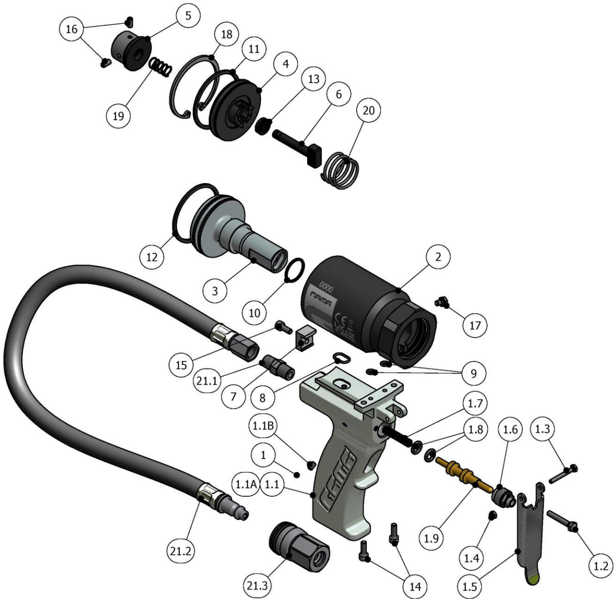
Figura 3. Ensamblaje Empuñadura y Cilindro Aire Pistola Master III
