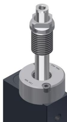
Posteriormente, deberá colocar y fijar la herramienta (3) a la camisa e introducir el empujador (4) en el vástago. Roscar hasta hacer tope.
