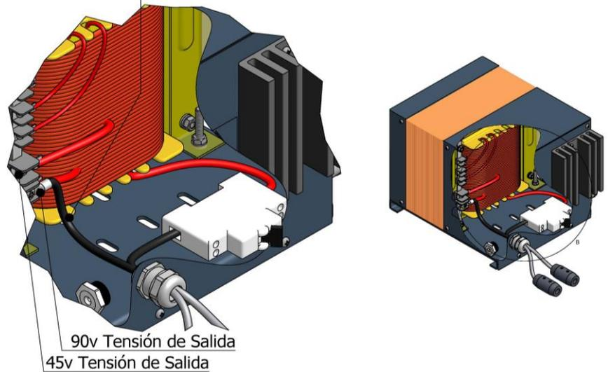
f) Conecte los cables eléctricos del sistema de calefacción de las mangueras de los productos al cuerpo conector "fast lock" de la salida del transformador, como se detalla a continuación:
