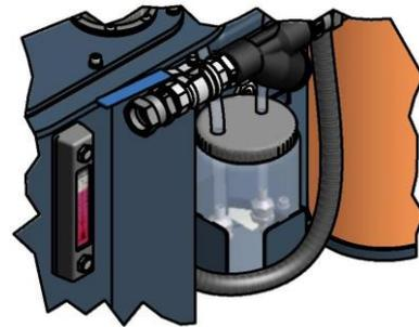
**¡PRECAUCIÓN!** Para evitar un exceso de presión en las mangueras calefactoras, espere a que el producto contenido en las mismas alcance la temperatura requerida antes de poner en marcha el sistema hidráulico.
