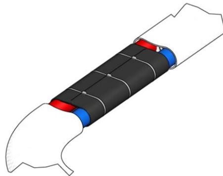
**NOTA:** Una vez colocada la sonda SCT de control de temperatura debe prestar especial atención en no golpear o doblar en exceso las mangueras. No enrolle las mangueras de forma que el radio sea inferior a un metro.
