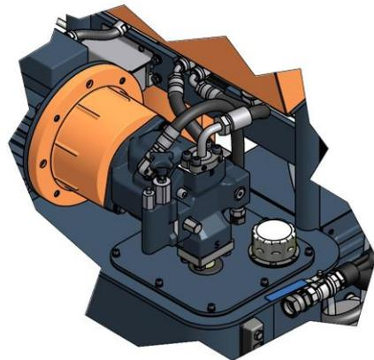
**NOTA:** No llene el depósito hasta su capacidad máxima (78 Lts.); verifique que la cantidad de aceite introducido no supera el 80% de la capacidad máxima (63 Lts. aprox). Utilice el visor del termómetro de aceite como referencia visual ya que el límite máximo de temperatura (80°C) coincide con la capacidad aconsejada.
