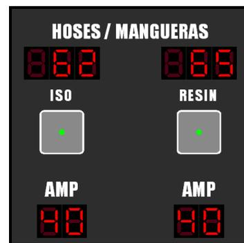
Para seleccionar la temperatura cuando la Unidad funciona en el modo de control automático de la calefacción, pulse la tecla MODE, seleccione la temperatura requerida pulsando las teclas SUBIR/BAJAR y vuelva a pulsar la tecla MODE para memorizar el valor seleccionado. Siga el mismo procedimiento para seleccionar los Amperios. Cuando la Unidad funciona en el modo de control automático el valor de la intensidad debe fijarse entre 45 y 50 Amperios.
