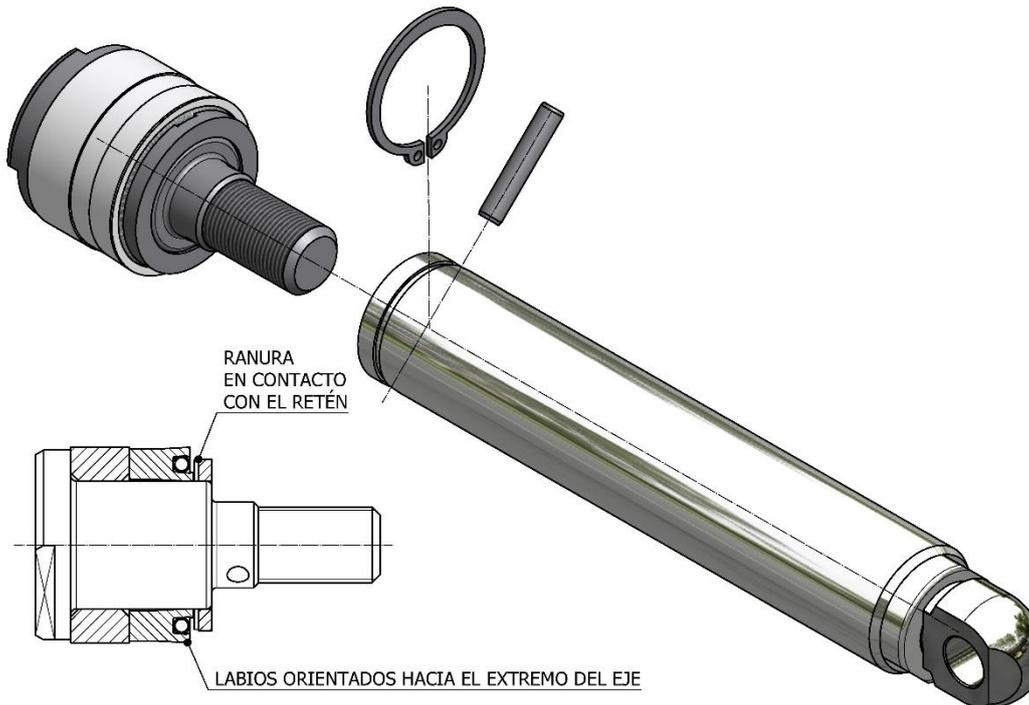
Insertar la guía, el retén y la arandela en la cabeza del émbolo. Orientar los labios del retén hacia el extremo del eje. Orientar las ranuras de la arandela hacia el retén.
