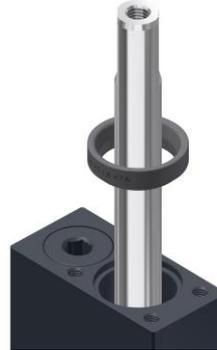
Una vez insertado el émbolo en la camisa, deberá montar el retén de la culata. Para ello deberá colocar primero la herramienta embudo retén (2).
